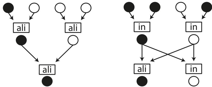
Razumemo desno sliko? Škatlici v zgornji vrsti sta "in". Leva dobi dva črna, zato da črnega. Desna nima dveh črnih, izhod je bel. Tadva žetona, črni in beli, gresta v dve škatlici. Leva spodnja je "ali": ker je eden od teh dveh žetonov črn, da škatlica na črn žeton. Desna škatlica pa je "in" in da bel žeton.,
